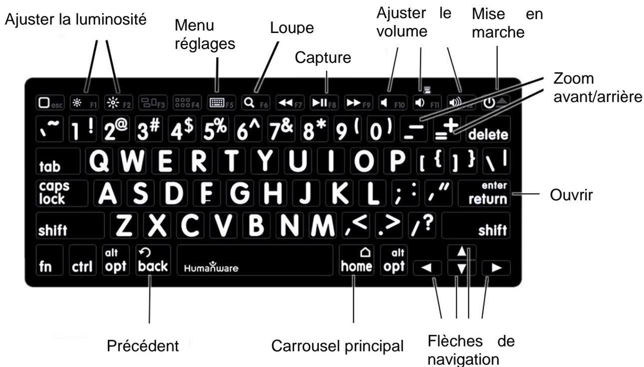
L'un des avantages du clavier Humanware est que toutes les touches sont imprimées en gros caractères faciles à lire. De plus, les icônes des commandes Prodigy fréquemment utilisées sont imprimées sur le clavier pour rappeler rapidement la fonction de la touche.
